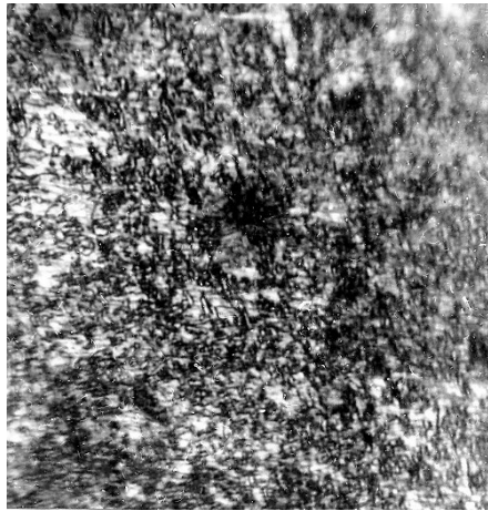
Рис. 6. Структура криці 12ХН3А після цементації, термоциклічного оброблення та гартування; бал зерна 8, \times 500 .
